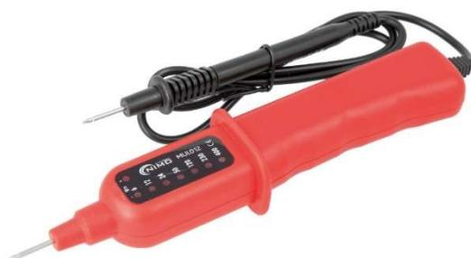
Comprobador de tensión diseñado únicamente para la medición por contacto, con indicación mediante diodos leds. No mantener la comprobación de tensión de manera continua, el tiempo máximo continuo no debe sobrepasar los 10 segundos especialmente en el caso de tensiones elevadas.
