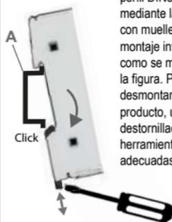
El producto se fija al perfil DIN35(A) mediante la pieza con muelle de montaje inferior, como se muestra en la figura. Para desmontar el producto, utilice un destornillador u otras herramientas adecuadas.
