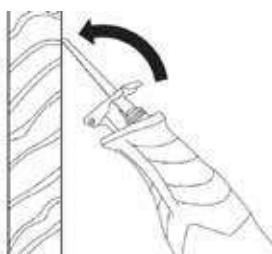
do curso, defina a velocidade máxima do curso. Pressione a ferramenta elétrica firmemente contra a peça de trabalho e deixe a lâmina afundar lentamente na peça de trabalho. Assim que o pé da lâmina estiver descansar totalmente na superfície da peça de trabalho e continue serrando ao longo da linha de corte desejada. Para certos trabalhos, a lâmina da serra também pode ser inserida girada em 180° e a serra alternativa pode ser guiada adequadamente de cabeça para baixo.
