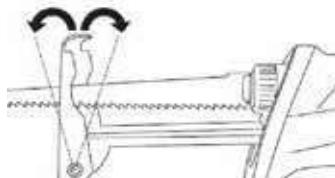
Si necesita reducir la capacidad de corte de su herramienta (profundidad de corte), la placa de pie pivotante se puede ajustar de la siguiente manera. Afloje el tornillo de fijación en la parte inferior de la carcasa frontal con una llave hexagonal. Deslice el pie de la hoja pivotante a la posición requerida. Apriete el tornillo y verifique que el pie de la cuchilla esté firmemente asegurado.
