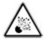
Cilindros contendo gases de proteção os armazenam em altas pressões. Se sofrerem algum tipo de avaria, podem explodir. Sempre trate os cilindros com cuidado e solde o mais longe possível deles.
