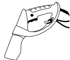
Impostare la connessione del macchina al cavo di prolunga inserendolo nel gancio di fissaggio del manubrio e inserirlo nella macchina.
