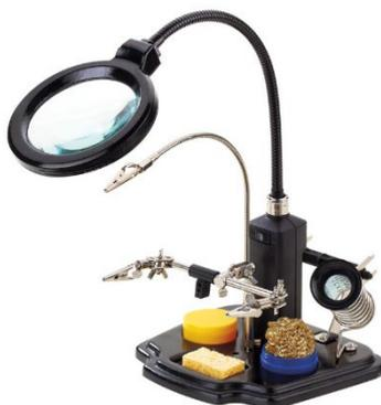
Lupa con luz LED integrada y accesorios para trabajos sin manos. Este dispositivo incluye soporte de soldador, pinzas de cocodrilo, soporte para carrete de hilo de estaño, caja con resina, y limpiador metálico en seco de puntas.
