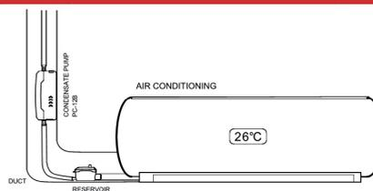
La bomba de condensados debe instalarse en un canal de una unidad de aire acondicionado con una potencia de hasta 8 kW
