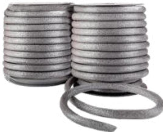
Cordón macizo de espuma de polietileno no reticulado de celda cerrada especialmente concebido para su aplicación como limitador de profundidad en todo tipo de sellados y juntas frías de dilatación (hasta +90°C).
