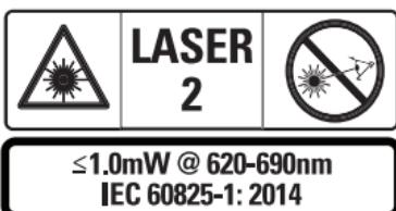
Az STHT7065 készülék az A ábrán látható módon ① egy látható lézersugarat bocsát ki magából. A kibocsátott lézersugár az IEC 60825-1 szerint 2. osztályú lézer.
