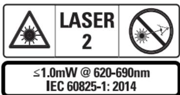
Seade STHT7065 kiirgab nähtavat laserikiirt, nagu näidatud Joonisel A ①. Seadmest tulev laserikiir kuulub standardi IEC 60825-1 kohaselt 2. laseriklassi.
