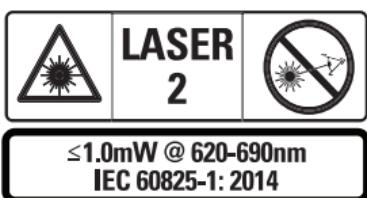
Инструментите STHT7065 излъчват видим лазерен лъч, както е показано на Фигура A ①. Излъзваният лазерен лъч е лазерен клас 2, съгласно IEC 60825-1.
