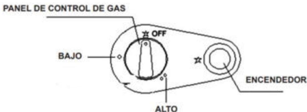
**NOTA:** cuando se enciende un nuevo calentador por primera vez, puede ser necesario mantener la perilla de control hacia abajo durante más tiempo para permitir que el gas fluya hacia el piloto. Una vez que el calentador está encendido en el ajuste 1-BAJO, girando el mando de control a la posición 2-ALTO encenderá el otro panel.
