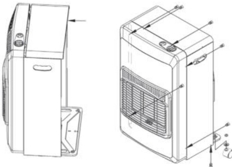
**4. FIJE TODOS LOS PANELES CON TORNILLOS, AJUSTE LA PARTE TRASERA Y MONTE LA RUEDAS CON LOS TORNILLOS SUMINISTRADOS.**
