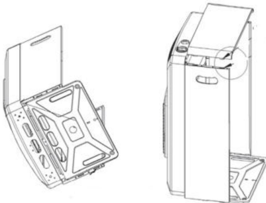
**3. ENCAJE LA PARTE SUPERIOR Y AJUSTE LOS TRES PANELES.**
