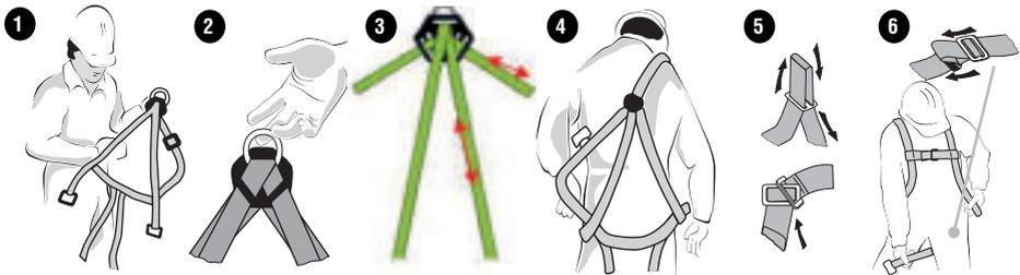
1.- Open het harness compleet. 2.- Pak het harness bij de ring aan de achterzijde. 3.- Pas de maatvoering aan middels de regelaar aan de achterzijde. 4.- Trek het harness aan met de regelaar en de ring aan de achterzijde. 5.- Op maat afstellen middels de metalen beugels op de borst en de plastic gesp. 6.- Stel de gespen af die bij de benen geplaatst zijn. Het harness moet zo zijn afgesteld dat elke beweging mogelijk is zonder enige belemmering.
