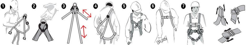
1.- Déplier complètement le harnais. 2.- Prendre le harnais par la boucle dorsale. 3.- Ajuster à la mesure de l'utilisateur par moyen du régulateur dorsal. 4.- Mettre le harnais avec le régulateur et la pioche située à l'arrière. 5.- Ajustez et attachez les boucles en métal pectorales et la boucle en plastique. 6.- Ajustez et attachez les boucles de jambe. 7. Ajustez et attachez la ceinture
