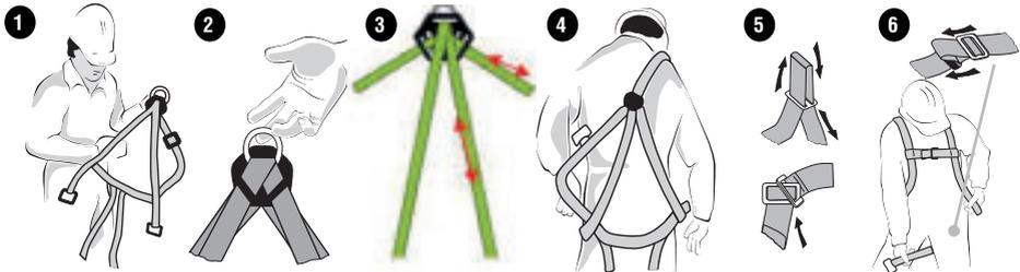
1.- Falten Sie das Gurt-Geschirr komplett auseinander. 2.-Nehmen Sie das Gurt-Geschirr an der Rückenschnalle auf. 3.-Mittels des Regulators im Rückenbereich die Ausrüstung anpassen. 4.-Streifen Sie das System mittels des Regulators und des Hakens im Rückenbereich über. 5.-Justieren und Festmachen der Metall-Schnallen im Brustbereich und der Plastikschnalle
