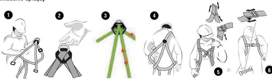
1.- Całkowicie rozłóż uprząż. 2.- Chwyc uprząż za tylną sprzączkę. 3.- Dopasuj do wzrostu użytkownika za pomocą regulatora grzbietu. 4.- Załóż uprząż z regulatorem i szpilką z tyłu. 5.- Wyreguluj i zapnij metalowe klamry na klatce piersiowej oraz plastikową klamrę. 6.- Wyreguluj i zamknij klamry na nogawkach.
