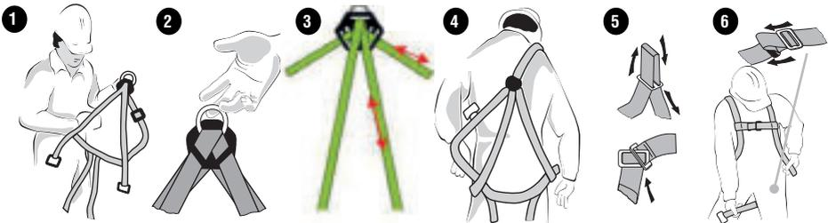
1.- Aprire completamente l'imbracatura. 2.- Prendi l'imbracatura dalla fibbia dorsale. 3.- Adeguare alla misurazione dell'utente tramite il regolatore dorsale. 4.- Indossare l'imbracatura con il regolatore e il moschettoni situati sul retro. 5.- Regolare e fissare le fibbie in metallo pettorale e la fibbia in plastica. 6.- Regolare e allacciare le fibbie delle gambe. L'imbracatura deve essere regolata in modo tale da consentire di eseguire tutti i movimenti senza alcun tipo di impedimento
