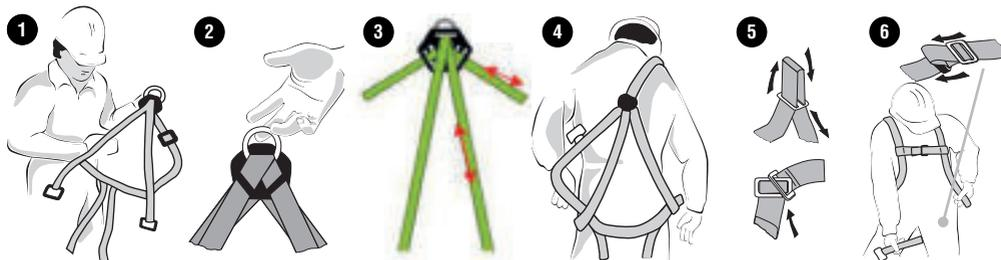
1.- Desfășurați complet hamul. 2.- Luați hamul de catarama dorsală. 3.- Reglați-vă la măsura utilizatorului cu ajutorul regulatorului dorsal. 4.- Puneți hamul cu regulatorul și picheta situate pe spate. 5.- Reglați și fixați cataramele metalice pectorale și catarama de plastic.
