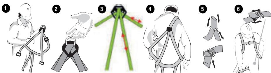
1.- Aprire completamente l'imbracatura. 2.- Prendi l'imbracatura dalla fibbia dorsale. 3.- Adeguare alla misurazione dell'utente tramite il regolatore dorsale. 4.- Indossare l'imbracatura con il regolatore e il moschettone situati sul retro. 5.- Regolare e fissare le fibbie in metallo pettorale e la fibbia in plastica. 6.- Regolare e allacciare le fibbie delle gambe. L'imbracatura deve essere regolata in modo tale da consentire di eseguire tutti i movimenti senza alcun tipo di impedimento
