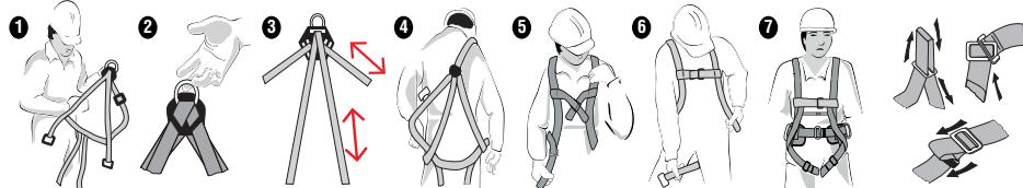
1.- Déployez complètement le harnais. 2.- Prendre le harnais par la boucle dorsale. 3.- Ajuster à la mesure de l'utilisateur par moyen du régulateur dorsal. 4.- Mettre le harnais avec le régulateur et la pioche située à l'arrière. 5.- Ajustez et attachez les boucles en métal pectorales et la boucle en plastique. 6.- Ajustez et attachez les boucles de jambe. 7. Ajustez et attachez la ceinture
