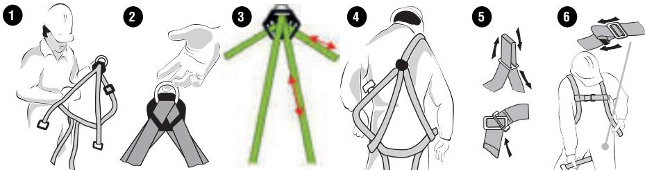
1.- Falten Sie das Gurt-Geschir komplett auseinander. 2.- Nehmen Sie das Gurt-Geschir an der Rückenschnalle auf. 3.- Mittels des Regulators im Rückenbereich die Ausrüstung anpassen. 4.- Streifen Sie das System mittels des Regulators und des Hakens im Rückenbereich über. 5.- Justieren und Festmachen der Metall-Schnallen im Brustbereich und der Plastikschnalle
