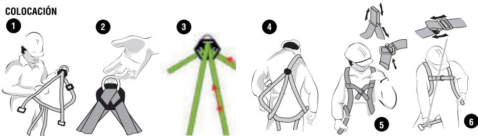
1.- Desplegar completamente el arnés. 2.- Coger el arnés por la hebilla dorsal. 3.- Ajustar a la medida del usuario mediante el regulador dorsal. 4.- Colocarse el arnés con el regulador y la piqueta situados en la espalda. 5.- Ajustar y abrochar las hebillas metálicas pectorales y la hebilla de plástico. 6.- Ajustar y abrochar las hebillas de las perneras.
