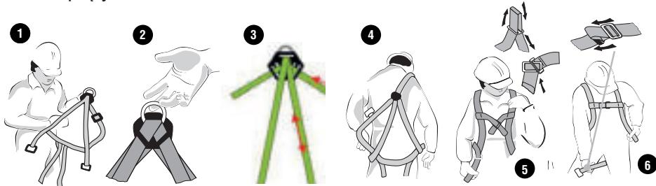
1. - Całkowicie rozłoż uprzęż. 2.- Chwyń uprzęż za tylną sprzączkę. 3.- Dopasuj do wzrostu użytkownika za pomocą regulatora grzbietu. 4.- Załącz uprzęż z regulatorem i szpilką z tyłu. 5.- Wyreguluj i zapnij metalowe klamry na klatce piersowej oraz plastikową klamrę. 6.- Wyreguluj i zamknij klamry na nogawkach.
