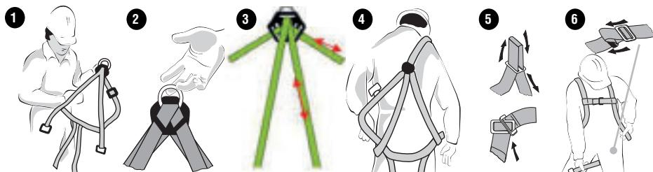
1.- Open het harnes compleet. 2.- Pak het harnes bij de ring aan de achterzijde. 3.- Pas de maatvoering aan middels de regelaar aan de achterzijde. 4.- Trek het harnes aan met de regelaar en de ring aan de achterzijde. 5.- Op maat afstellen middels de metalen beugels op de borst en de plastic gesp. 6.- Stel de gespen af die bij de benen geplaatst zijn. Het harnas moet zo zijn afgesteld dat elke beweging mogelijk is zonder enige belemmering.
