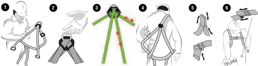
1.- Desfășurați complet hamul. 2.- Luati hamul de catarama dorsala. 3.- Reglați-vă la măsura utilizatorului cu ajutorul regulatorului dorsal. 4.- Puneți hamul cu regulator și pichele situate pe spate. 5.- Reglați și fixați cataramele metalice pectorale și catarama de plastic.
