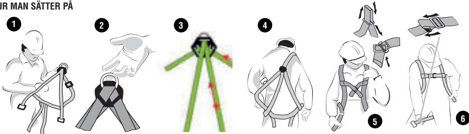
1.- Fäll ut selen helt. 2.- Ta tag i selen i det bakre spännet. 3.- Justera till användarens höjd med krönregulatorn. 4.- Sätt på selen med justeraren och stift bak. 5.- Justera och fäst metallspännen på bröstet och plastspännet. 6.- Justera och stäng benspännenna.
