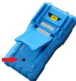
1. Abra la batería o el compartimento del fusible con un destornillador adecuado.
