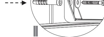
Utilizzare le viti "Vs" e le rondelle "Rs" in dotazione per fissare la squadretta "Sts" al tettuccio dell'armadio (fig I). Successivamente fissare la squadretta "Sts" alla parete (fig II). Per il fissaggio al muro utilizzare viti\* e tasselli\* adeguati alla tipologia di parete a disposizione \* NOT INCLUDED
