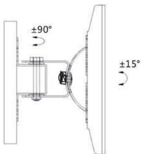
Mova a placa de parede para cima e para baixo na direção desejada usando a chave (H). Depois de obter o ângulo desejado, aperte os parafusos de ajuste.
