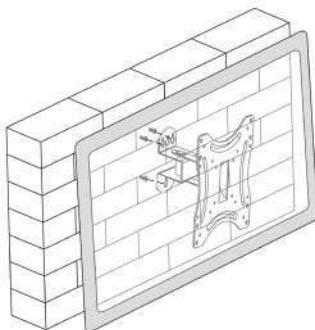
Pendure a placa de parede nos parafusos resistentes, observe que a pequena cabeça está voltada para cima. Em seguida, aperte os parafusos de alta resistência.
