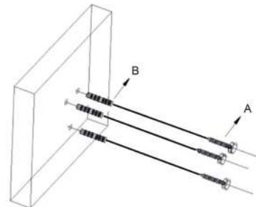
Taladre tres agujeros en la pared teniendo cuidado de medir las distancias para encajar en la base. Inserte los tres anclajes de plástico (b) en los orificios y luego inserte los tres tornillos resistentes (A) en los anclajes. Use un taladro para asegurar.
