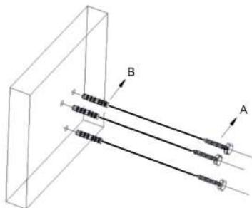
Faça três furos na parede tomando cuidado para medir as distâncias para encaixar a base. Insira as três âncoras de plástico (b) nos orifícios e, em seguida, insira os três parafusos reforçados (A) nas âncoras. Use uma furadeira para proteger.
