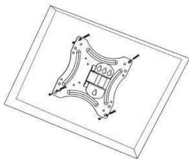
Instale a TV na placa de parede usando as peças C, D ou E que se adaptam melhor à sua TV. As arruelas (F ou G) são fornecidas para garantir um melhor encaixe.
