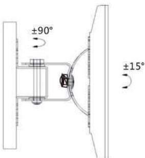
Mueva la placa de pared hacia arriba y hacia abajo en la dirección deseada utilizando la llave (H). Una vez que tenga el ángulo deseado, apriete los tornillos de ajuste.
