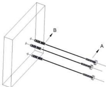
Percez trois trous dans le mur en prenant soin de mesurer les distances pour s'adapter à la base. Insérez les trois chevilles en plastique (b) dans les trous, puis insérez les trois vis robustes (A) dans les chevilles. Utilisez une perceuse pour sécuriser.
