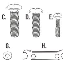
C. Parafuso de fixação M6x20 (4x)
