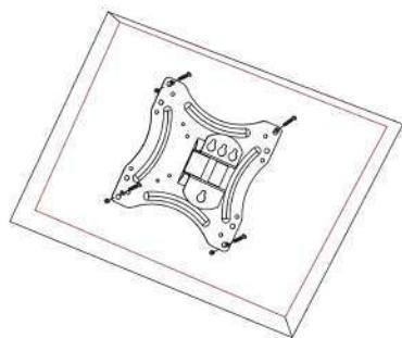
Instale el televisor en la placa de pared utilizando las piezas C, D o E que mejor se adapten a su televisor. Las arandelas (F o G) se proporcionan para asegurar un mejor ajuste.
