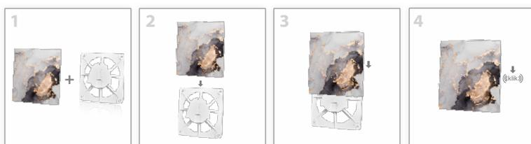
Montaż panelu na kratce (widok z tyłu)
