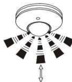
Orientación incorrecta del movimiento
