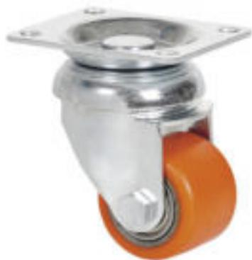
Ruedas con núcleo metálico y banda de poliuretano vulcanizado con una dureza 95° shore A. Especialmente indicada para soportar cargas hasta 100 Kg con mínima altura.
