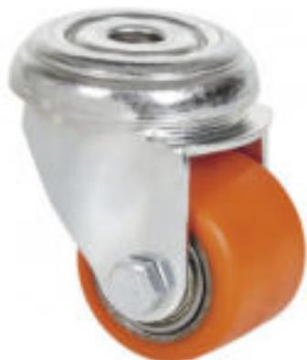
Ruedas con núcleo metálico y banda de poliuretano vulcanizado con una dureza 95° shore A. Especialmente indicada para soportar cargas hasta 100 Kg con mínima altura.
