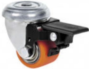
Ruedas con núcleo metálico y banda de poliuretano vulcanizado con una dureza 95° shore A. Especialmente indicada para soportar cargas hasta 100 Kg con mínima altura.
