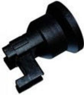
Portalámparas E-27 provisional de obra. Cuerpo de una pieza, conexión sin tornillos, para cable de sección de 0,5 a 2,5 mm<sup>2</sup>.
