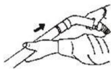
Montagem do tubo de extensão na mangueira
