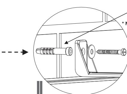
Utilizzare le viti "Vs" e le rondelle "Rs" in dotazione per fissare la squadretta "Sts" al tettuccio dell'armadio (fig I). Successivamente fissare la squadretta "Sts" alla parete (fig II). Per il fissaggio al muro utilizzare viti\* e tasselli\* adeguati alla tipologia di parete a disposizione \* NOT INCLUDED
