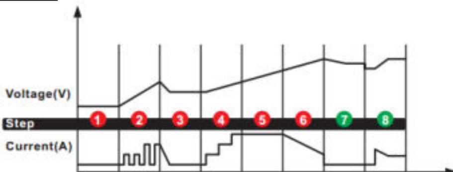
**PASO 1: DIAGNÓSTICO** (Verifica que la batería está conectada y que la tensión es correcta para iniciar la carga)
